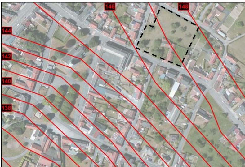
Le site se situe à l'intérieur **des courbes de niveaux allant de 148 à 146 mètres**. Le dénivelé maximal qui est présent sur le site est par conséquent de 2 mètres.
