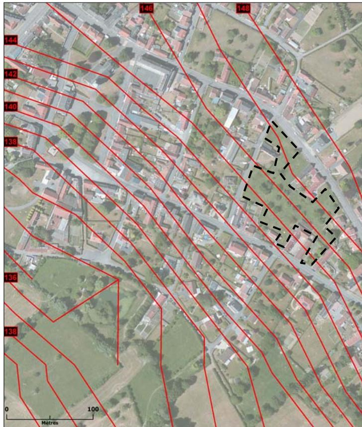
Le site se situe à l'intérieur **des courbes de niveaux allant de 147 à 144 mètres**. Le dénivelé maximal qui est présent sur le site est par conséquent de 3 mètres.
