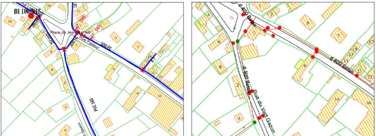
*A gauche, le réseau d'eau potable et à droite, le réseau d'assainissement*
