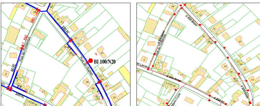
*A gauche, le réseau d'eau potable et à droite, le réseau d'assainissement*
