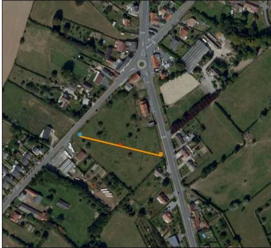
La coupe topographique ci-dessous montre que l'altitude passe de **141 à 142 mètres sur un tracé d'une longueur de 140 mètres**. Cela représente **une pente moyenne assez faible** de l'ordre de **0,71%**.
